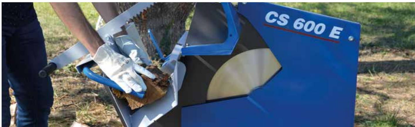
Les scies circulaires conviennent parfaitement pour **la découpe du bois en bûches** jusqu'à 21,5 cm de diamètre (selon les modèles). Leur lame circulaire effectue des **coupes rapides** à travers les bûches. Pour garantir une coupe efficace et durable dans le temps, **les lames sont en carbure de tungstène**.
